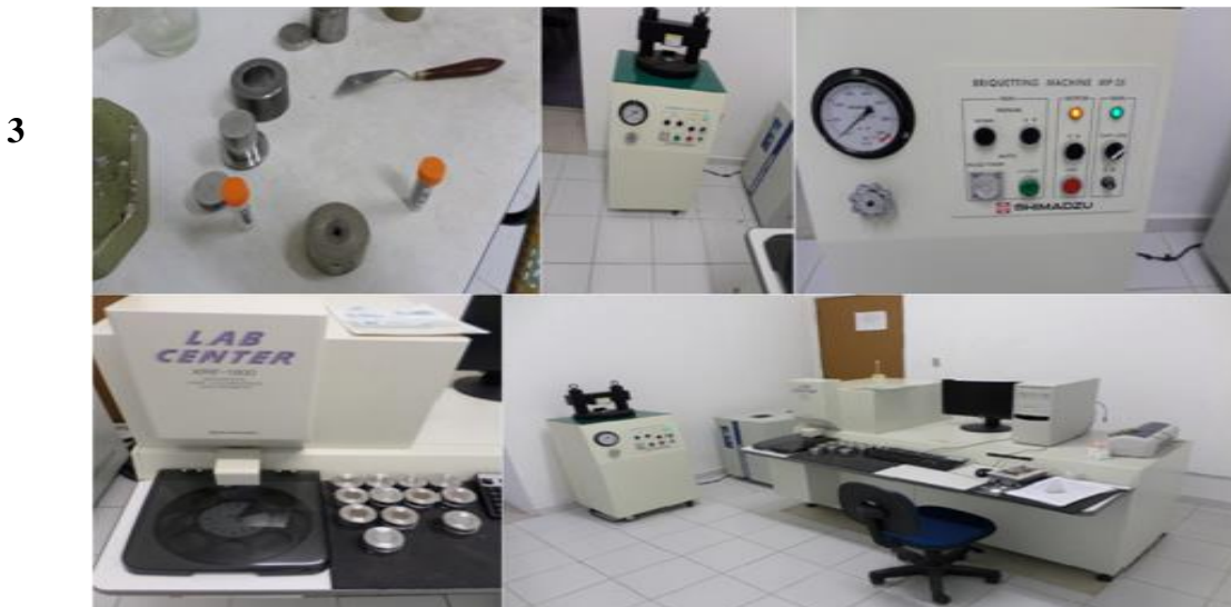
Figura 9: Processo de preparação do ensaio de Fluorescência de Raio X
