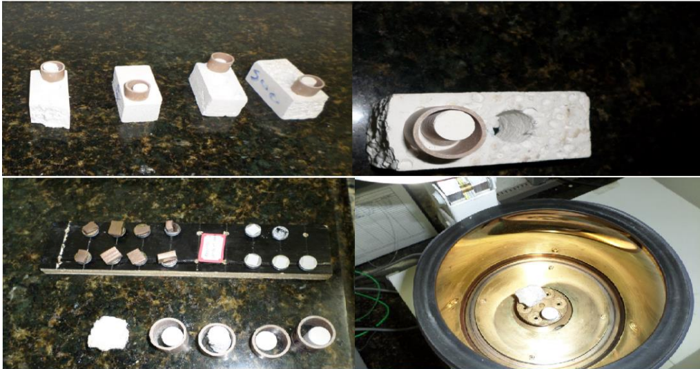
Figura 8: Preparação das amostras e metalização do material para o MEV
