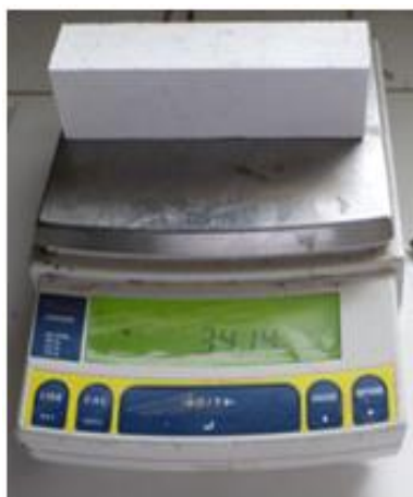
Figura 3: Corpo de prova sendo pesado para o cálculo da densidade
