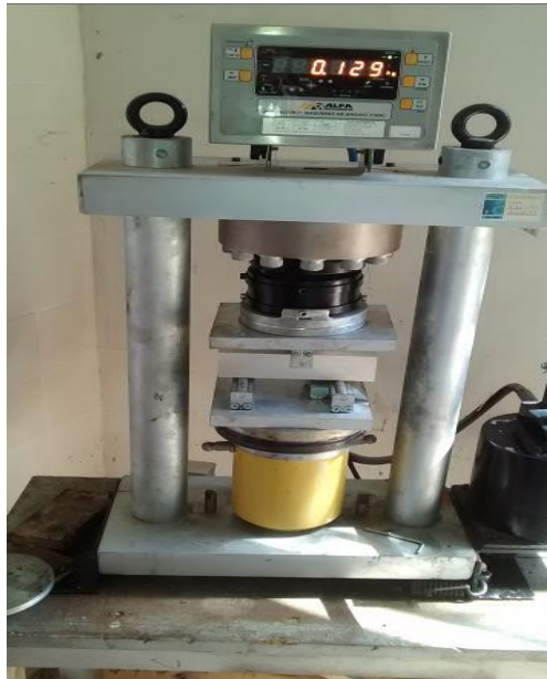
Figura 5: Ensaio de resistência à flexão
