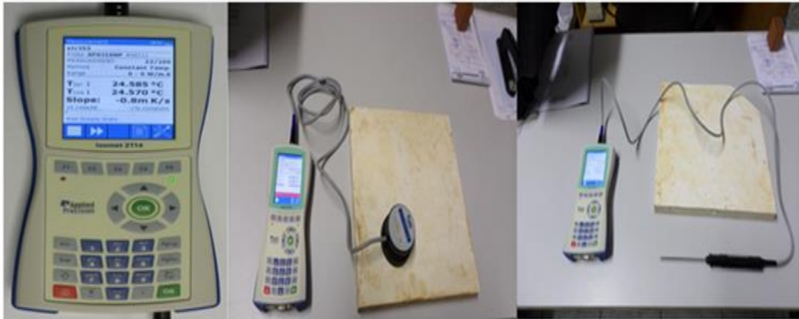
Figura 7: Aparelho Isomet 2114 sendo utilizado numa placa 30 mm x 300 mm x 300 mm
